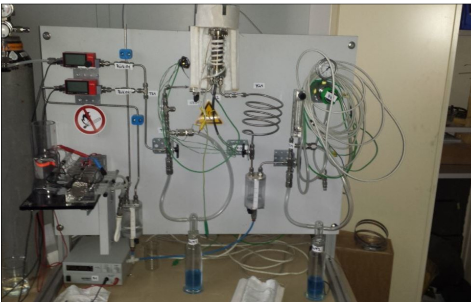
Erweiterter Power-to-Methan Versuchsstand
