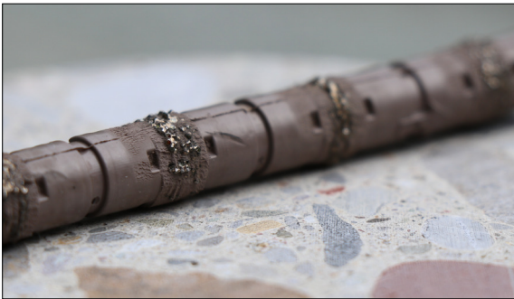
Diamantbesetzte Seilsäge (Quelle: Marc Furrer)
