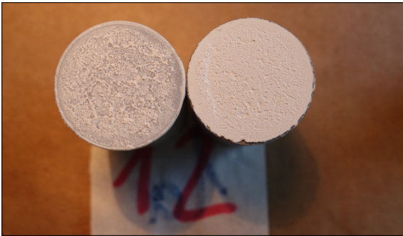
Bruchbild einer Standartzugversuchsprobe mit 3in1 Lack, rein kohäsiv in der Lackschicht gebrochen
