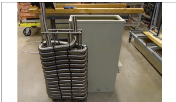
Wärmeübertrager DN32 und Speicherbehälter
