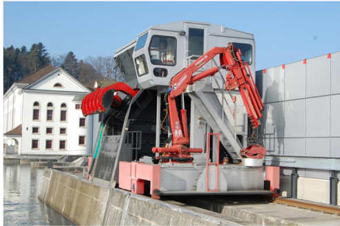
Rechenreinigungsmaschine, welche den Einlaufrechen von Wasserkraftwerken reinigt
