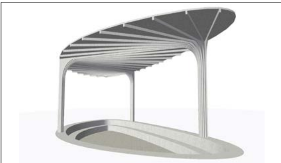
Gedeckter Pausenunterstand – Konstruktion aus ultrahochfestem Beton UHPC
