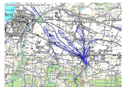
Bild 4: Überflutungskarte 300-jähriges Hochwasser mit Integralprojekt
