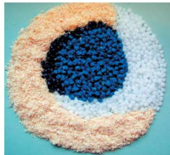
**Bild 1.** Holzfasern (links außen), Matrixkunststoff (rechts) und Farb-Masterbatch mit Additiven (links innen) sind die Ausgangsmaterialien für Holzfasern-Kunststoff-Granulate (Mitte)
