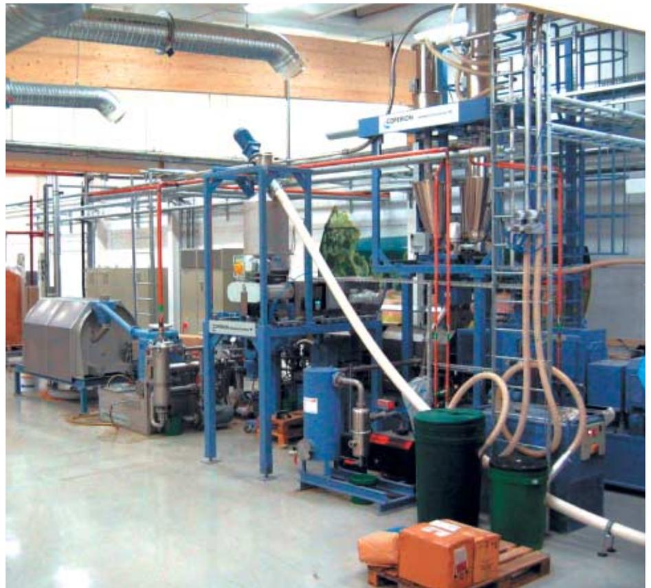
**Bild 4. Ein zweiwelliger Schneckenknetter mit 76 mm Schneckendurchmesser zur Produktion von bis zu 1000 kg/h Holzfaserkunststoff-Composites**
