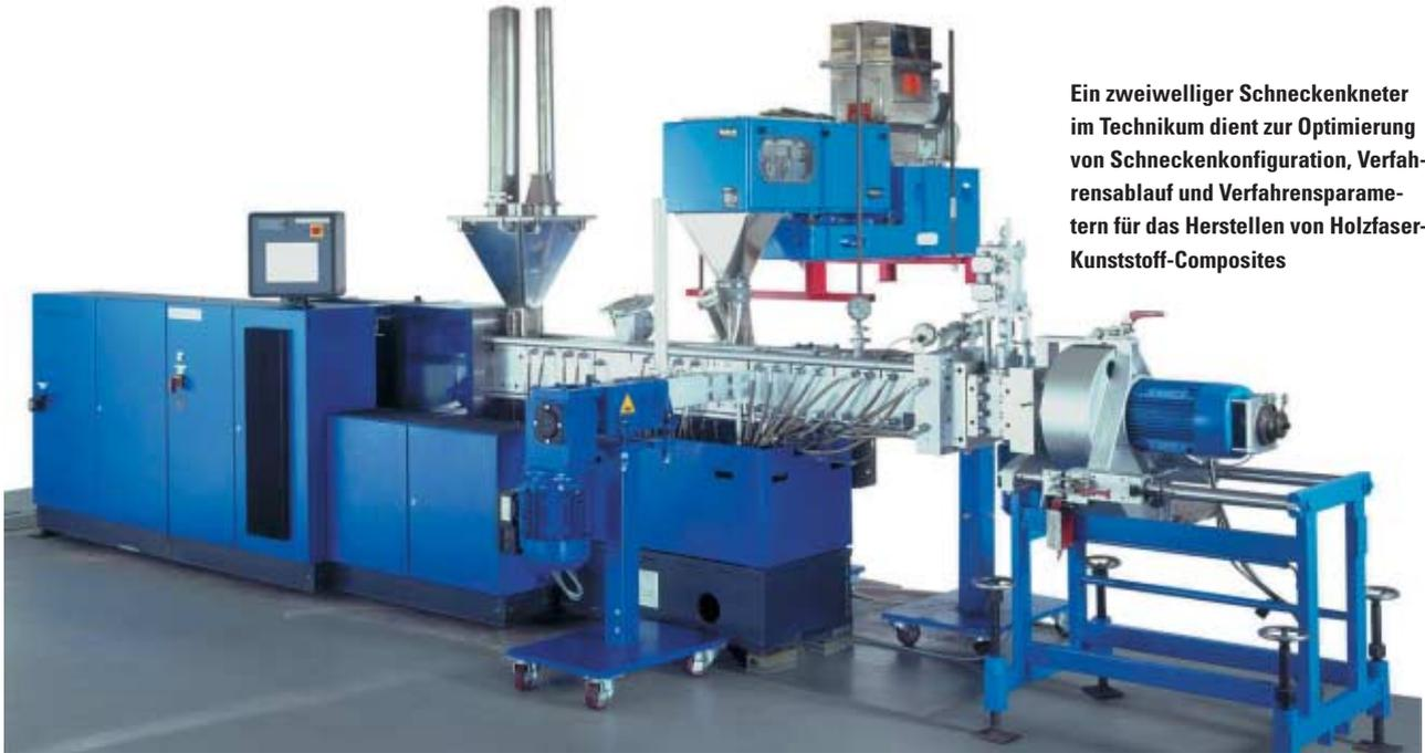
Ein zweiwelliger Schneckenknetter im Technikum dient zur Optimierung von Schneckenkonfiguration, Verfahrensablauf und Verfahrensparametern für das Herstellen von Holzfaserkunststoff-Composites
