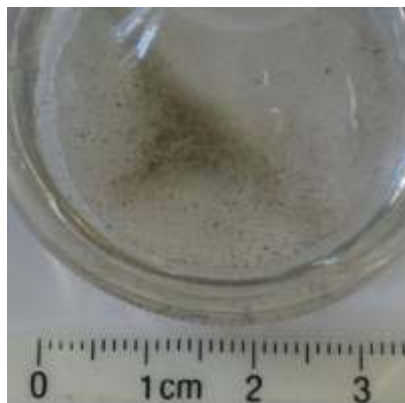
Verunreinigung aus drei Litern Jet-Fuel
